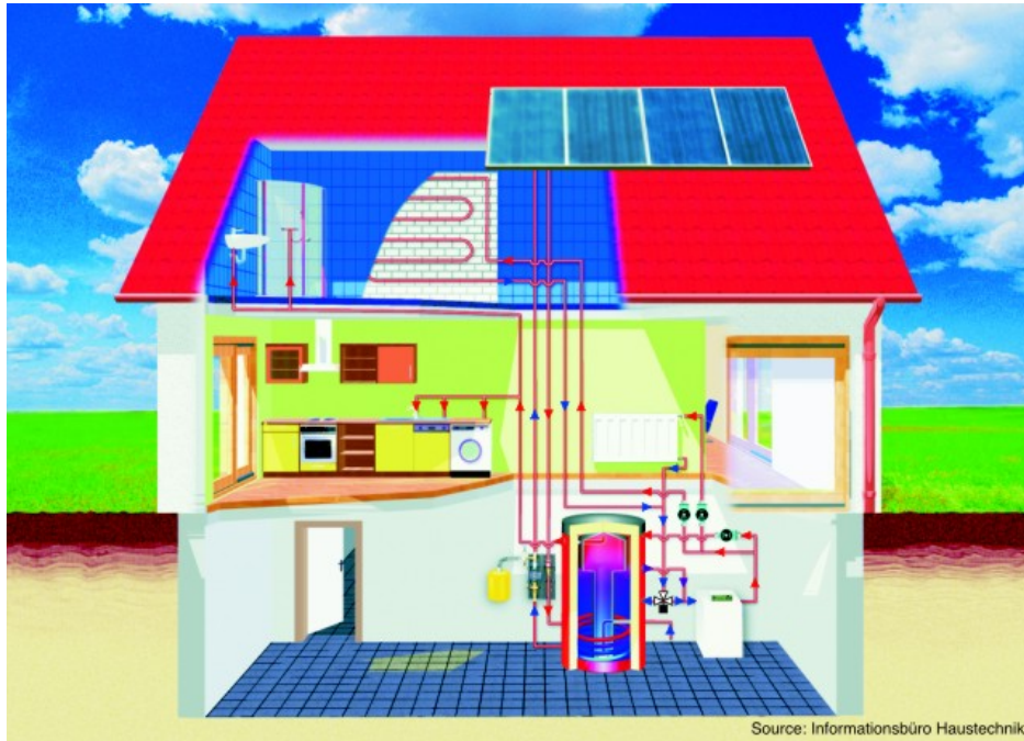
Vivienda con sistema combinado. ACS, electrodomésticos y calefacción. Diagrama cortesía ESTIF
