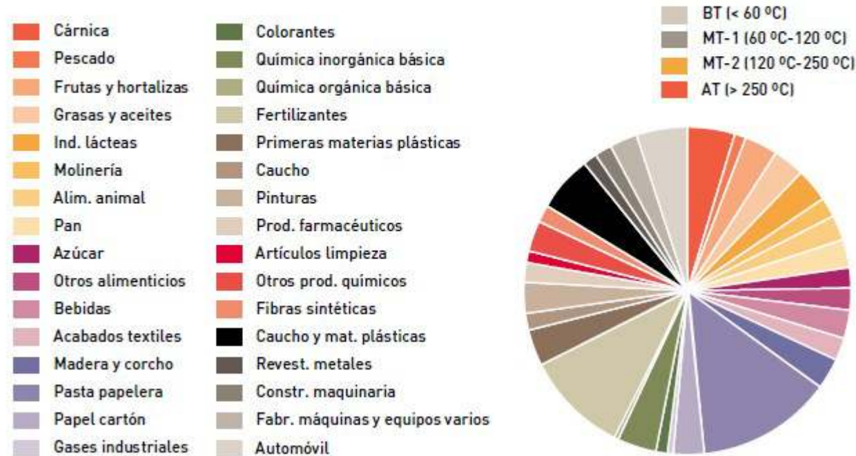
Figura 3.1.1. Distribución de la demanda de calor a baja y media temperatura entre los sectores analizados
